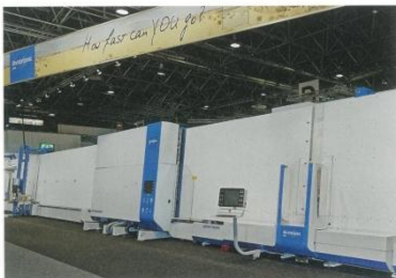
Bei der Speed Line hat Bystronic nach eigenen Angaben die drei notwendigen Arbeitsschritte optimal auf die Fertigung von Dreifacheinheiten ausgerichtet, dies ermöglicht kürzere Taktzeiten.
