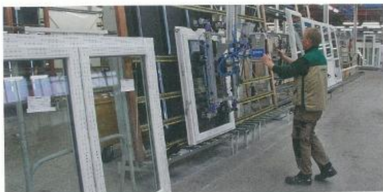
Starre Lastführung und verstellbare Saugteller machen den Easy-Lift zum verlässlichen Handlinggerät für Isolierglas.
