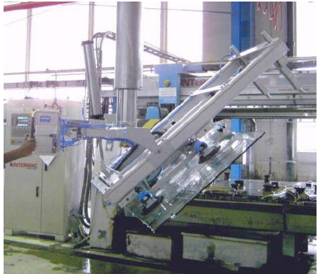
Kippen von der Vertikalen in die Horizontale (Ausführung kurze Laufschiene)
