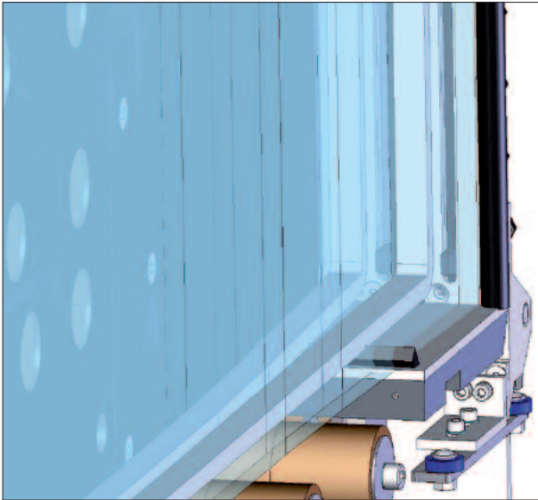
Befüllen der Dreifach-Isolierglaseinheit mit Edelgas
