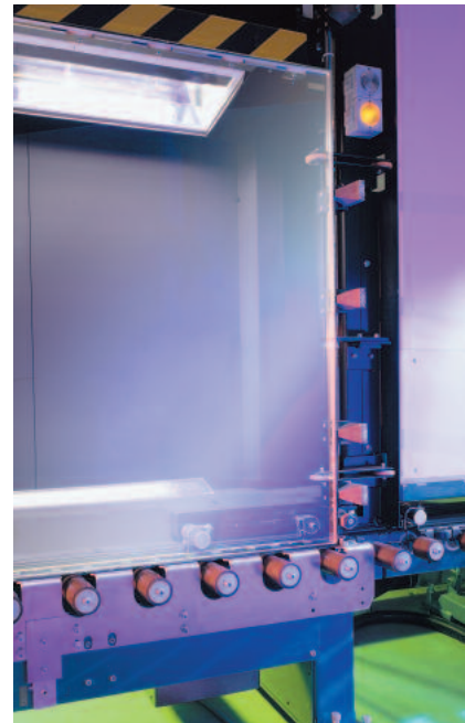
Automatische Einstellung der Rahmenansläge auf die jeweilige Glasdicke
