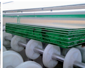
Beschusssicheres Glas (Multilayer) bestehend aus sieben Scheiben in fünf verschiedenen Glasdicken
